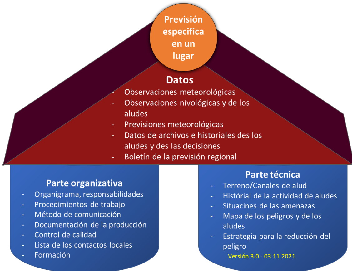
Figura 2 Ilustración esquemática de la configuración propuesta para un servicio de previsión de un alud específico en un lugar
